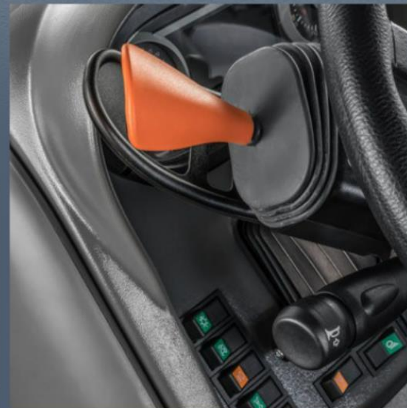
Obr. 8. Ovládanie reverzácie v traktore Zetor Proxima CL [4]
